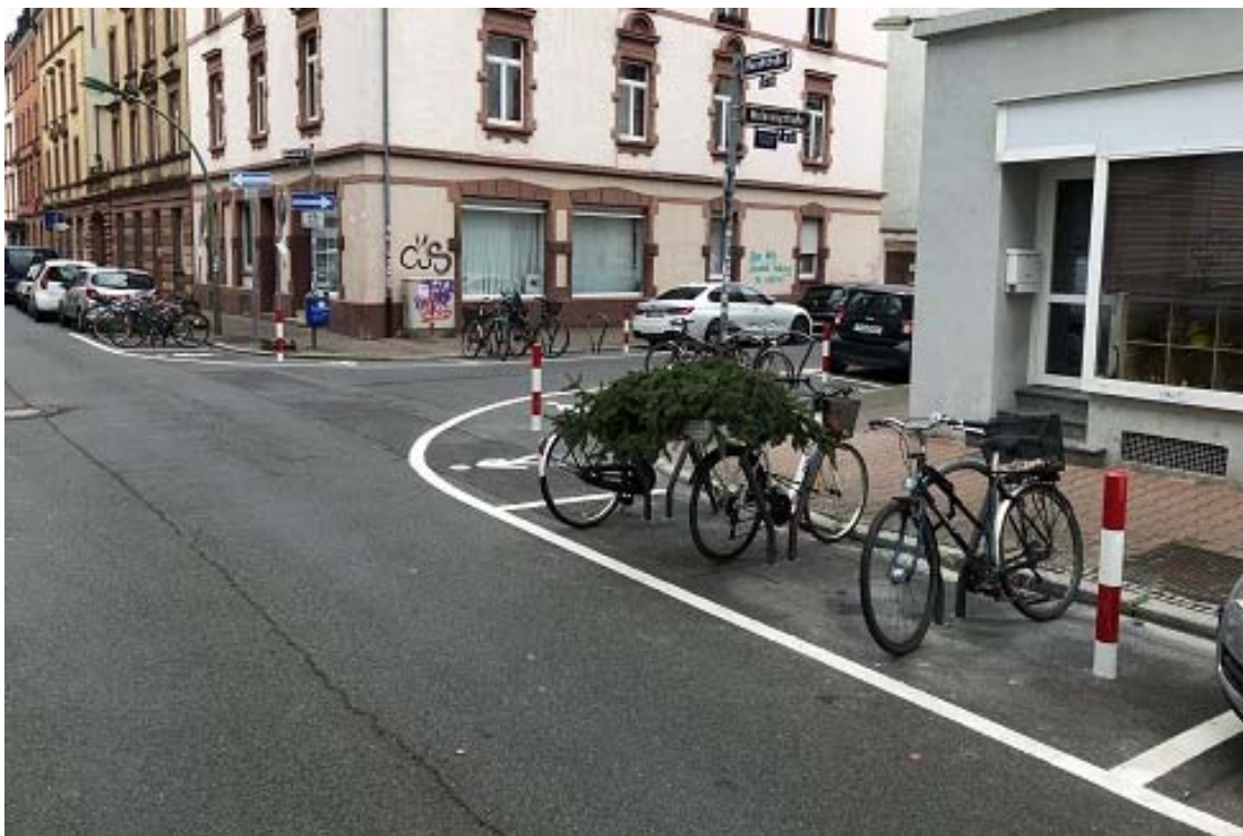
Bild 2: Statt Schraffur ist auch ein Fußgänger*innen-Piktogramm als Bodenmarkierung möglich. (Kreuzung Basaltstraße/Mulanskystraße in Frankfurt am Main. Foto: Jan Annendijck, Stadt Frankfurt)
